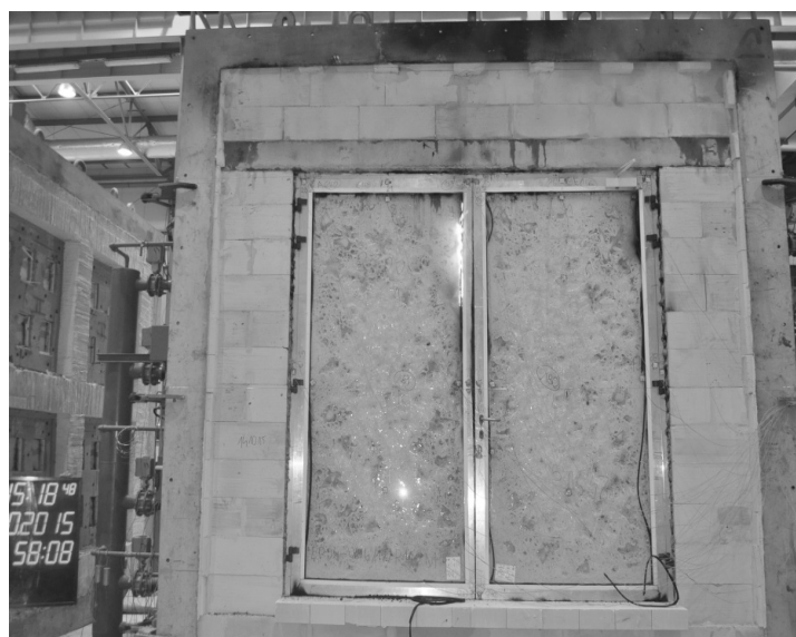
Rys. 1. Przykład przekroczenia kryterium szczelności – utrzymywanie się płomienia wzdłuż profilu skrzydła drzwiowego przy krawędzi zamkowej od strony przeszklenia wypełniającego skrzydło bierne
