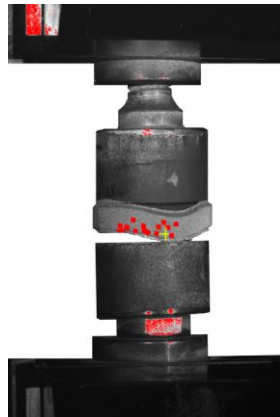
Fig. 3. Tearing of the specimen Rys. 3. Rozrywanie próbki
