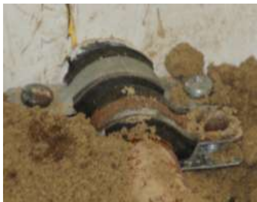
Rys. 2. Obejma zapewniająca jednakową szerokość szczeliny po każdym rozszczelnieniu przewodu
