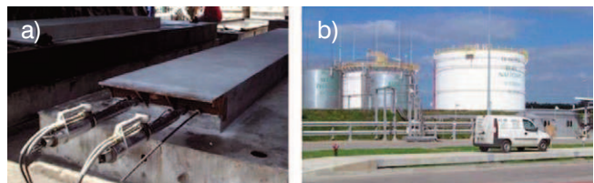
Rys. 5. Sprężanie prototypu płyty (a), widok pomostu wagi w miejscu użytkowania (b).
