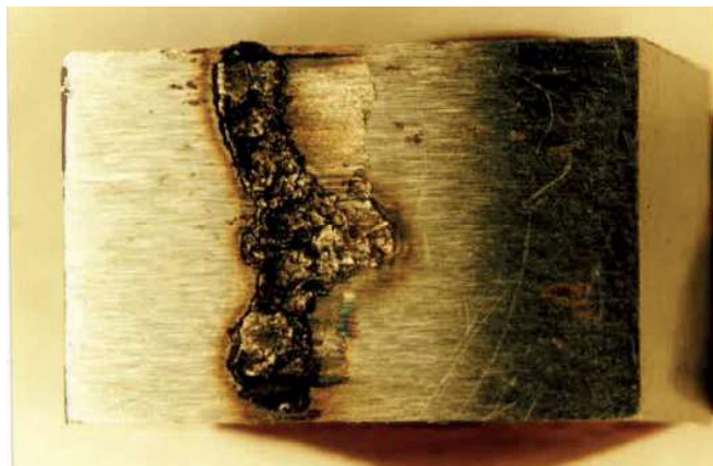
Rys. 19. Stal 50 HSA - przedstawia obraz zatartej próbki stalowej, z tą różnicą, że widoczne jest wyraźnie pole, w którym nastąpiło miejscowe nadtopienie materiału próbki. Fakt ten świadczy o bardzo wysokiej temperaturze w strefie kontaktu. Na obu próbkach widoczny jest obszar znacznego zużycia ściernego.
