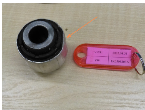
Rys. 5. Uszkodzona próbka. Strzałka wskazuje miejsce deformacji zewnętrznej tulei. Fig. 5. Damaged sample. The arrow indicates the location of the deformation of the outer sleeve.
