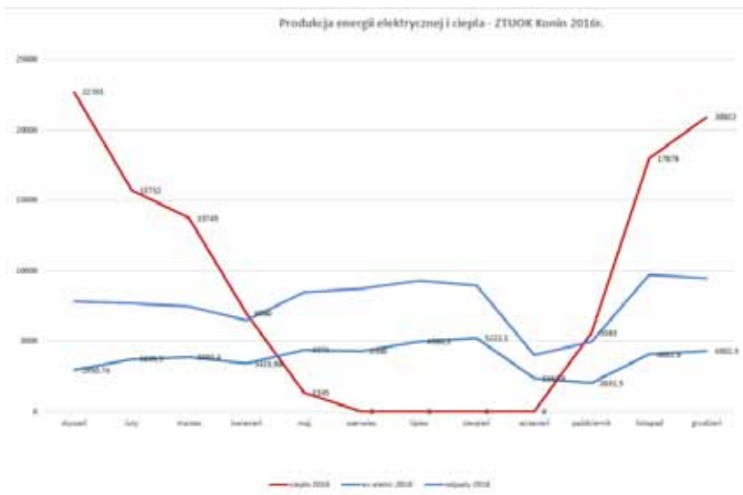
Rys. 7. Produkcja energii elektrycznej i energii cieplnej w kogeneracji w ZTUOK Konin w 2016 r.
