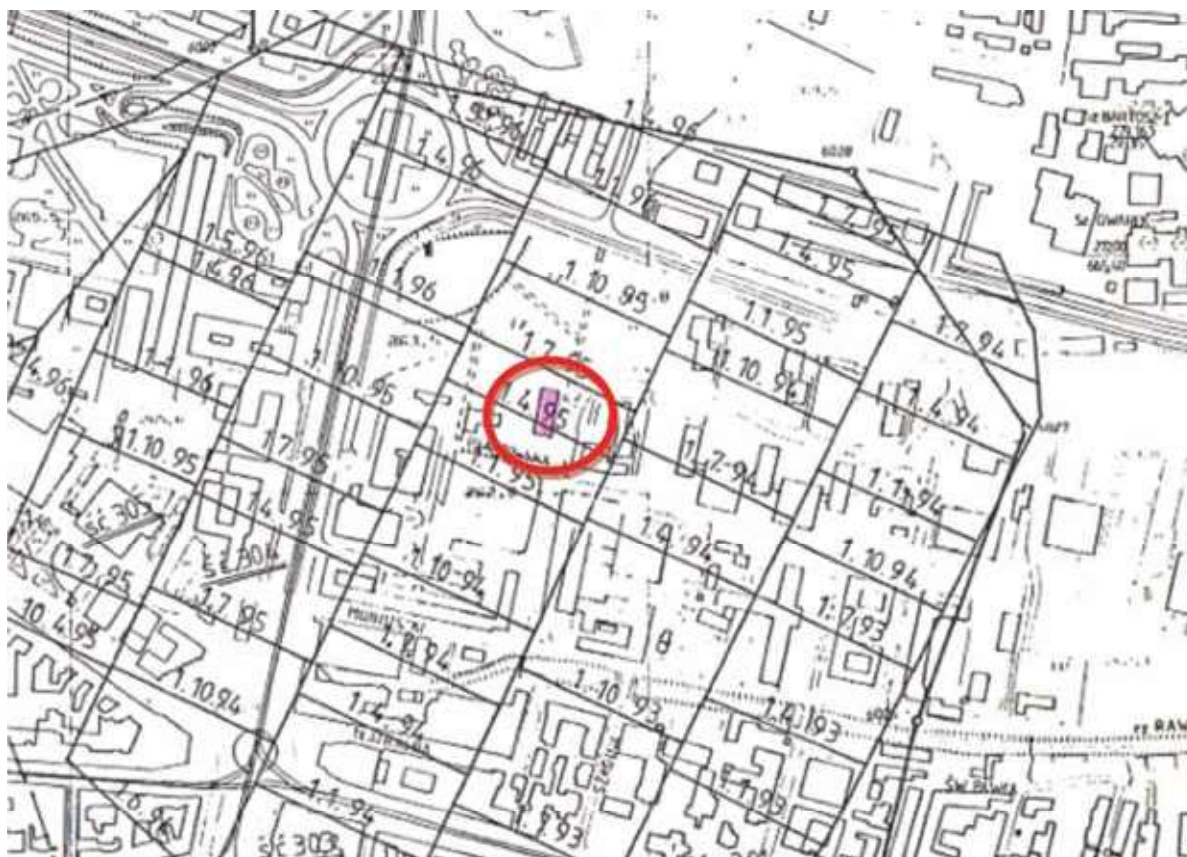
Rys. 3. Eksploatacja KWK „Katowice” prowadzona w pokładzie 501 wraz z lokalizacją analizowanego budynku
