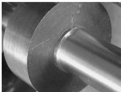
Rys.1. Połączenie wciskowe wałek-tulejka (pow. 2,5x)
