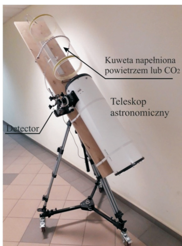
Rys. 10. Widok mobilnego zestawu pomiarowego do pomiaru transmisji promieniowania podczerwonego z Księżyca w dwutlenku węgla
