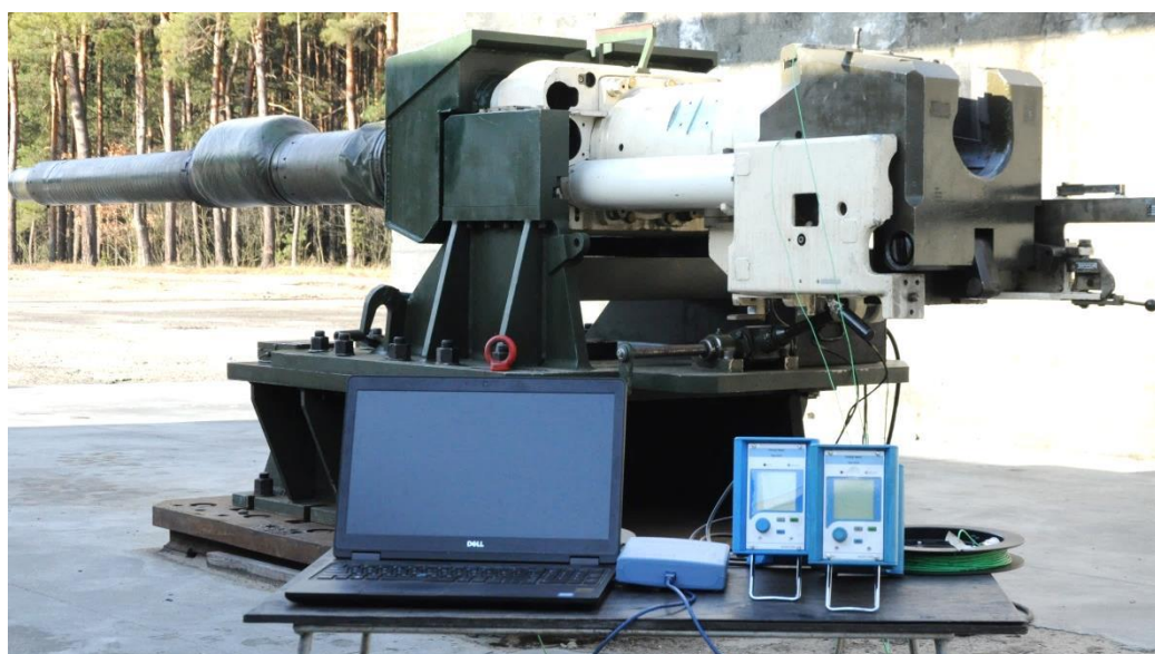
Fot. 2. Układ pomiarowy do określania ciśnienia negatywnego Photo 2. Measurement setup for determination of the negative pressure
