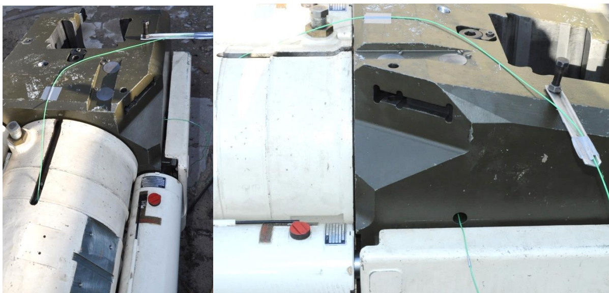
Fot. 1. Gniazda do montażu czujników piezoelektrycznych Photo 1. Openings housing piezoelectric sensors
