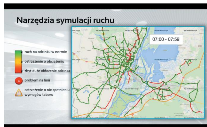
Rys. 3. Symulacja planowanego ruchu pojazdów służących do przewozu pasażerów przy wykorzystaniu platformy City Line Designer [37]
