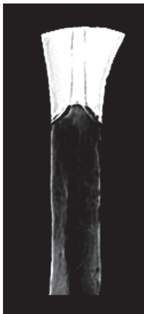
Ryc. 8. Zdjęcie RTG rękojeści kordu ukazujące jego warstwową budowę Fig. 8. X-ray photo of the short sword hilt revealing its layered structure
