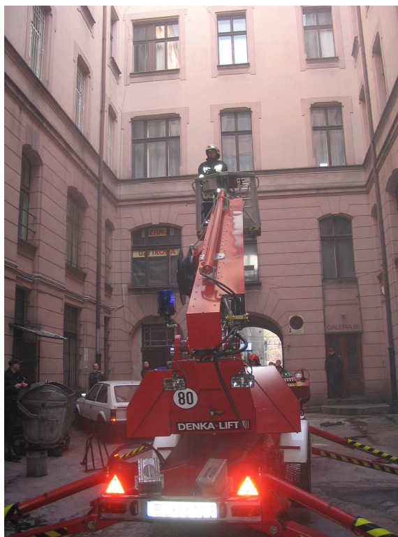
Fot.3 Specjalny podnośnik „Denka Lift”. Podnośnik charakteryzuje się bardzo małymi wymiarami w pozycji transportowej co umożliwia mu wjazd przez wąskie bramy.
