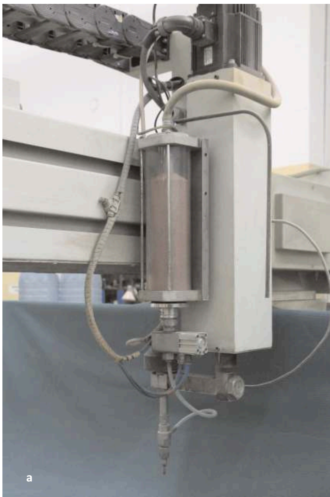
Rys. 2. Widok rezultatów badań wycinarki DWJFB 1313: a) zespół mieszania ścierniwa z wodą, b) dysza wylotowa mieszaniny
