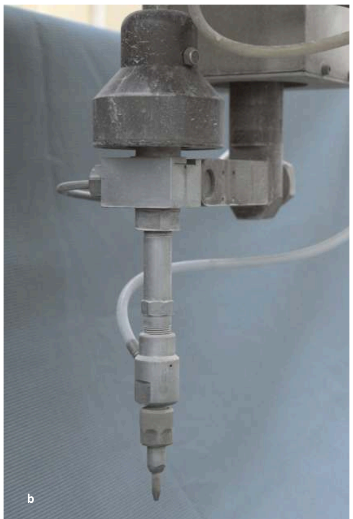
Rys. 2. Widok rezultatów badań wycinarki DWJFB 1313: a) zespół mieszania ścierniwa z wodą, b) dysza wylotowa mieszaniny
