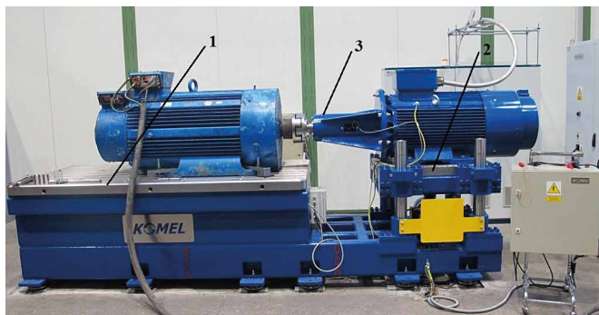
Rys. 1. Stanowisko hamowni (część maszynowa)
