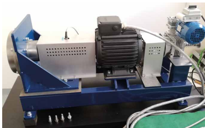
Rys. 3. Stanowisko montażowe hamowni 15 kW
