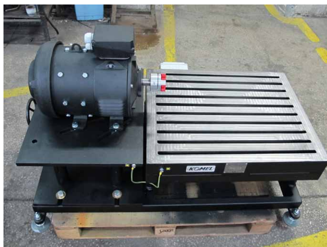
Rys. 2. Stanowisko montażowe hamowni 9 kW
