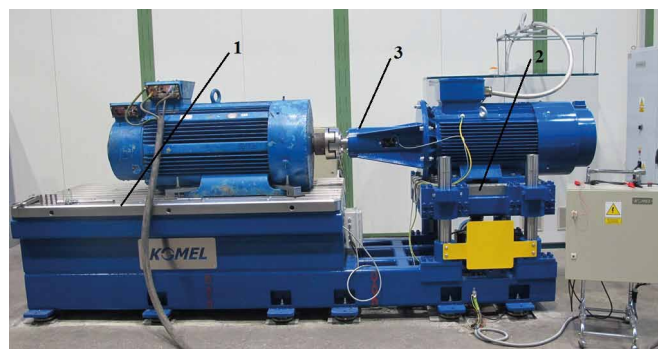
Rys. 1. Stanowisko montażowe hamowni 200 kW
