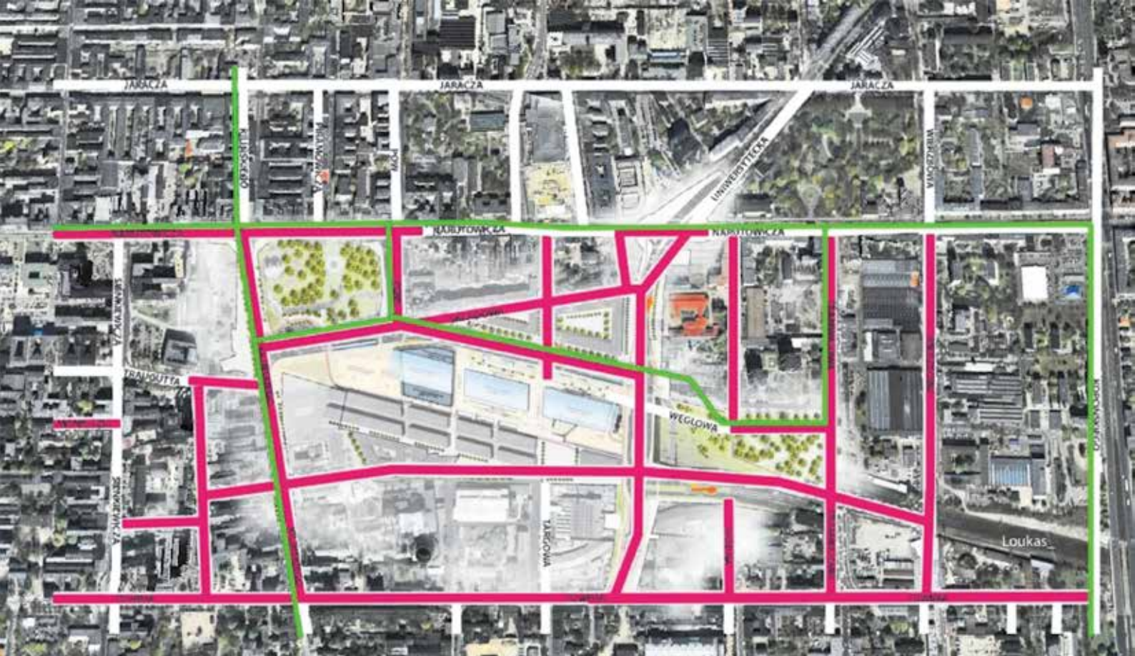
Rys. 2. Zakres inwestycji miejskich wokół dworca Łódź Fabryczna. Kolor zielony oznacza przebudowę lub budowę linii tramwajowych, kolor czerwony układ drogowy Źródło: Zarząd Dróg i Transportu.
