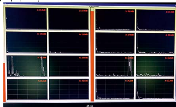
Rys. 13. Monitory rejestrujące badania UT wagonu ultradźwiękowego Fig. 13. Monitors recording UT tests of an ultrasonic wagon
