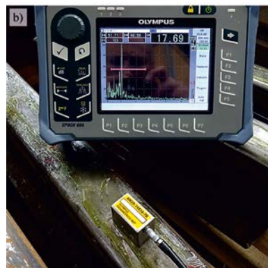
Rys. 8. Wewnętrzne pęknięcie zmęczeniowe, oznaczenie 211: (a) widok pęknięcia, (b) badanie UT szyny, wada 211 Fig. 8. Internal fatigue crack, designation 211: (a) crack view; (b) UT test of rail, defect 211
