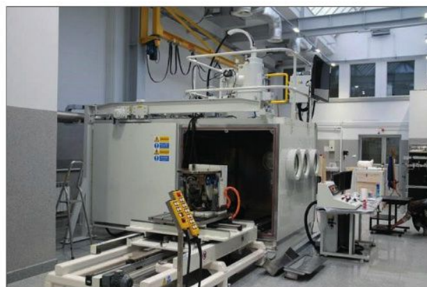
Fot. 2. Urządzenia elektroneowe do spawania i modyfikowania powierzchni w Łukasiewicz – Instytucie Spawalnictwa
