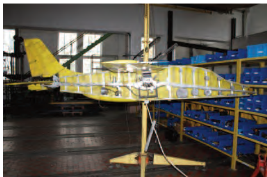
Rys. 2. Rzeczywisty model dynamicznie podobny samolotu w skali 1:4 [opracowanie własne]
