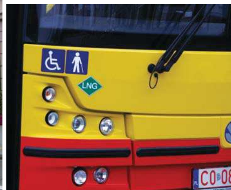
Jedynymi elementami, które odróżniają autobus zasilany LNG od autobusu z klasycznym napędem, są dodatkowe wymienniki ciepła zamontowane w tylnej części dachu oraz mała nalepka na ścianie czołowej
