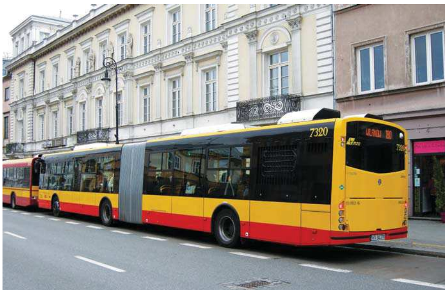
Jedynymi elementami, które odróżniają autobus zasilany LNG od autobusu z klasycznym napędem, są dodatkowe wymienniki ciepła zamontowane w tylnej części dachu oraz mała nalepka na ścianie czołowej
