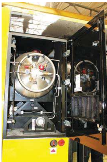
Kriogeniczny zbiornik umożliwia zmagazynowanie ciekłego gazu ziemnego w temperaturze rzędu -160^{\circ}\text{C} , co umożliwia pokonanie ponad 350 km pomiędzy tankowaniami
