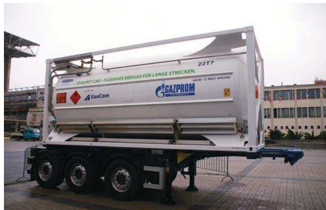
Możliwość tankowania autobusu z mobilnych stacji LNG powoduje, że wprowadzenie do eksploatacji nowego typu paliwa nie wymaga prowadzenia kosztownych prac infrastrukturalnych na terenie zajezdni
