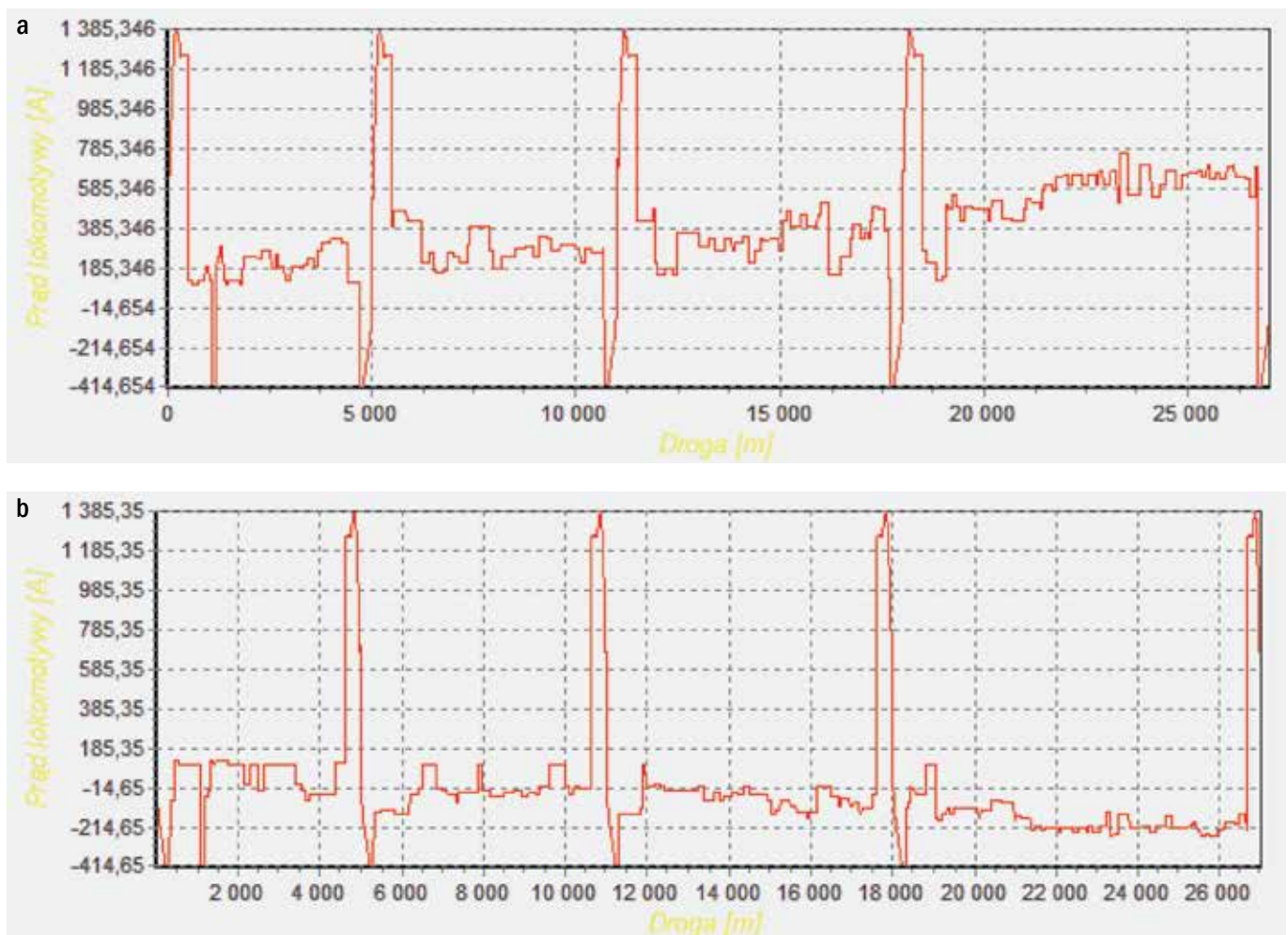
Rys. 3. Prąd pociągu typu P1 przy jeździe – a) tam: 0–26 000 m, b) powrót: 26 000–0 m
