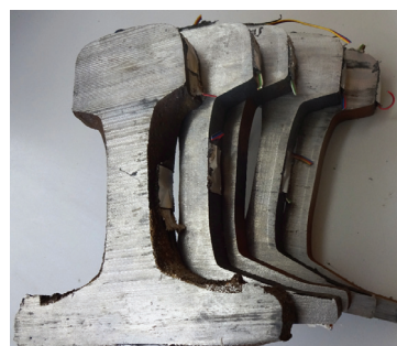
Rys. 5. Wycięte templety z szyn i złączy szynowych z tensometrami [fot. I. Mikłaszewicz]
