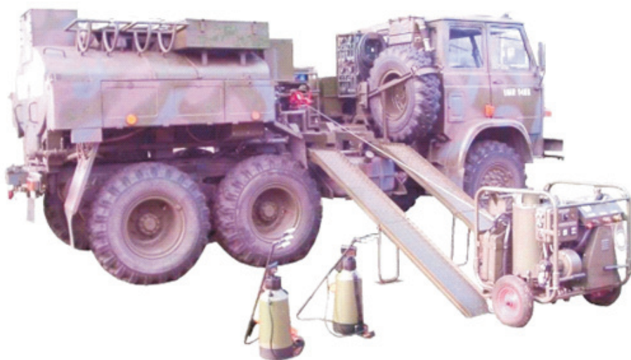
Rys. 9. Instalacja IRS 2C z zdjętym urządzeniem SANIJET C.921 [19]
