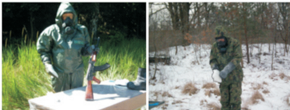
Rys. 18. Likwidacja skażeń broni strzeleckiej i elementów wyposażenia rękawicą z nanosorbentami [24]
