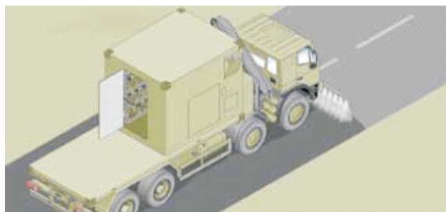
Rys. 14. TEP 90, moduł numer 1, likwidacja skażeń powierzchni utwardzonych
