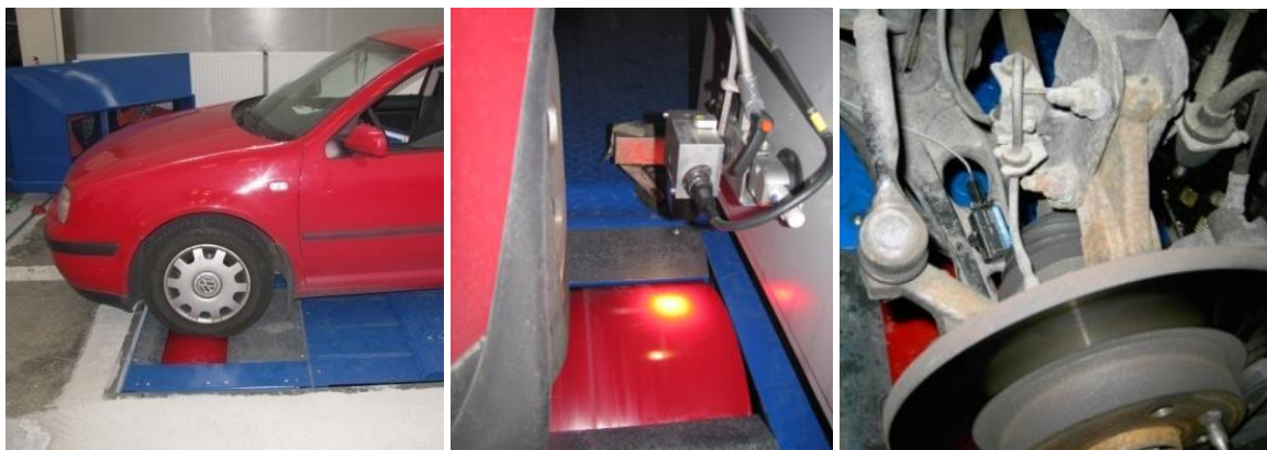
Rys. 1. Stanowisko pomiarowe: a) pojazd badawczy, b) głowica do pomiaru prędkości rolki hamowni, c) czujnik przyspieszenia zamocowany do wahacza.
