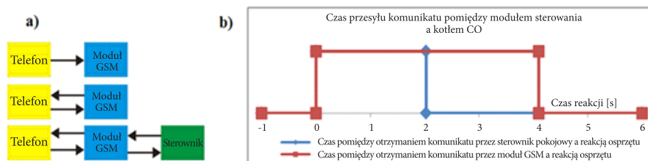
Rys. 5. a) Sposoby komunikacji bezprzewodowej w eksploatowanym systemie grzewczym; b) czas przesyłu komunikatu pomiędzy modulem sterowania a kotłem CO
