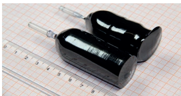
Rys. 4. Monokryształy \text{CaMoO}_4 : 0,5 % at. Nd, 0,5 % at. Eu., (u dołu o orientacji [001], u góry o orientacji [100]).
