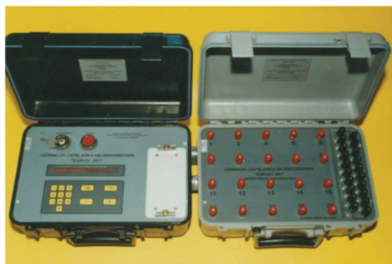
Rys. 2. Górnicza zapalarka milisekundowa Explo-201 (Biessikirski 1996)
