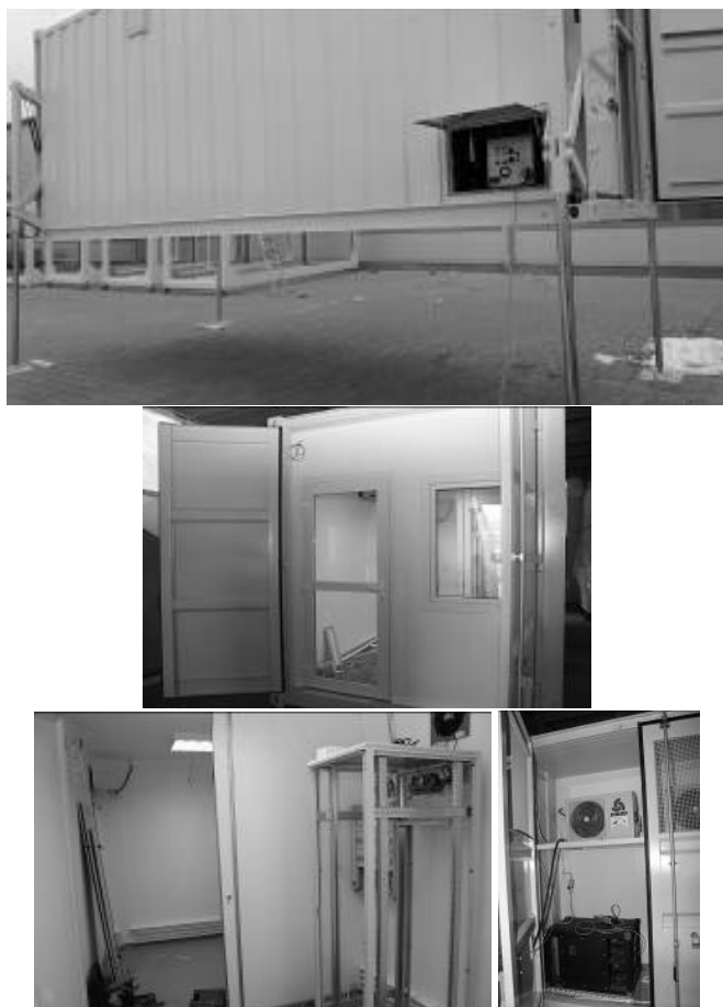
Ryc.8. Elementy budowanego mobilnego symulatora stanowiska kierowcy
