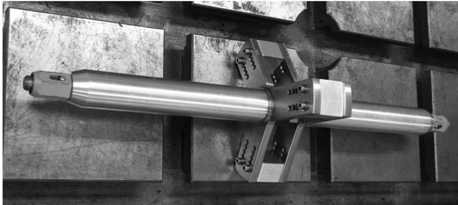
Figure 6.4.: Ogólny widok zaprojektowanego w ramach niniejszej pracy elementu o zmiennej sztywności osiowej
