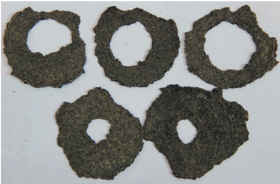
Fot. 4. Bitumen mass layer samples after resilience analysis with method of drop hammer (uneven breakthrough) Fot. 4. Próbkki powłoki masy bitumicznej po badaniu udarnościi metodą młota spadowego (nierównomierne przebicie)
