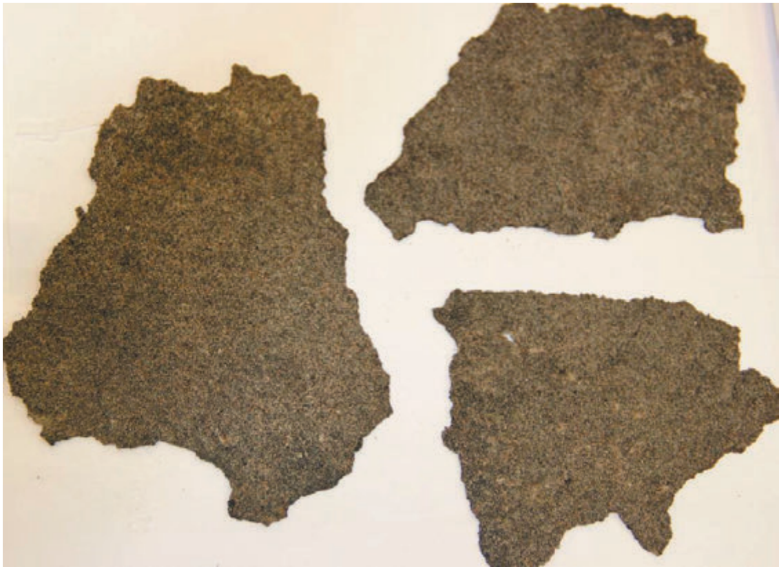
Fot. 3. Bituminous mass samples before resilience analysis Fot. 3. Próbkki testowe z masy bitumicznej przed badaniem udarnościi
