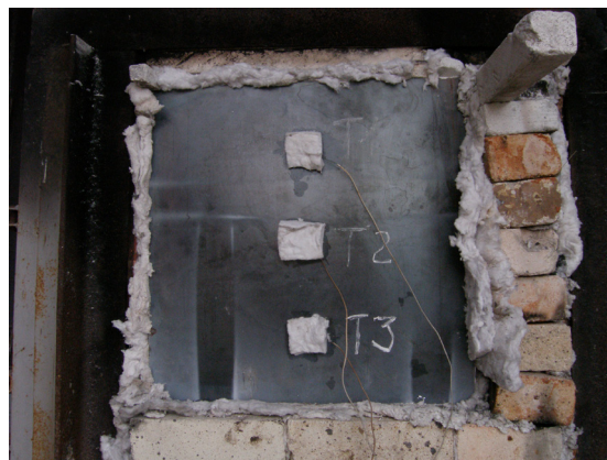
Рис. 2. Схема размещения термопар с необогреваемой поверхности стальной пластины Fig. 2. Scheme of distribution of thermal couples on the cool-touch surface of steel plate
