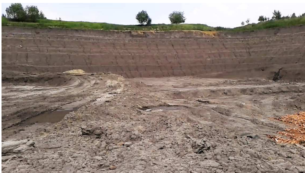
Fot. 1 Północna ściana wyrobiska w Gnaszynie z widocznymi poziomami eksploatacji.
