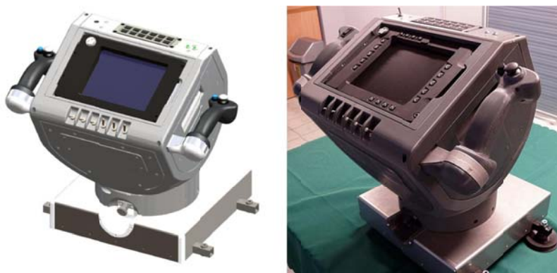
Rys. 6. Widok izometryczny pulpitu sterującego: po lewej model CAD, po prawej model rzeczywisty
