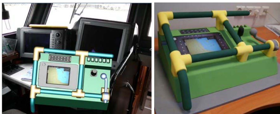
Rys. 1. Wybrany model wirtualny pulpitu sterowania oraz jego prototyp fizyczny
