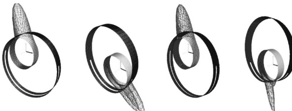
Fig. 11. Pressure distribution in bearing for medium clearance (drawings on the right with shaft misalignment) Rys. 11. Rozkłady ciśnień dla panewki z luzem średnim (rysunki po prawej z ukosowaniem wału)
