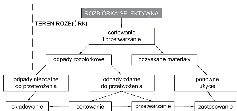
Rys. 5. Przepływ materiału pochodzącego z rozbiórki selektywnej, wg [3]
