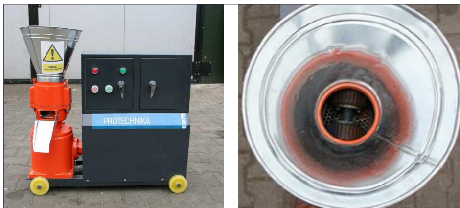
Rys. 6. Komercyjny granulator (peleciarka) z matrycą płaską Fig. 6. Commercial flat die pellet mill
