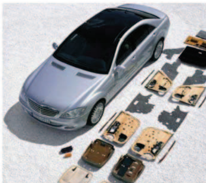
Rys.4. Elementy samochodu wykonane z kompozytów WPC [53] Fig. 4. Car components made of WPC composites[53]
