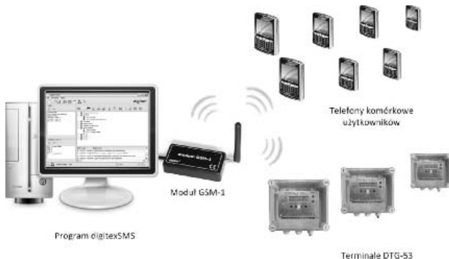
Rys. 3. Schemat systemu digitexSMS firmy Platan
