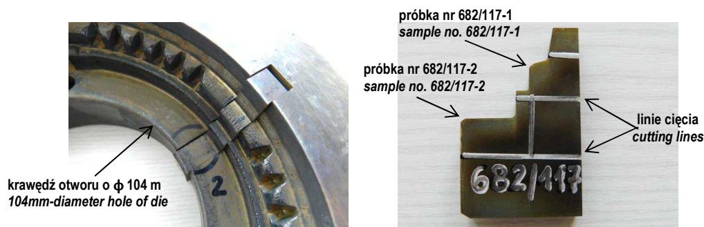
Rys. 4. Rozkrój matrycy nr 682/117 (a) i miejsca pobrania próbek nr 682/117-1 i 682/117-2 (b) Fig. 4. Cutting of die no. 682/117 (a) and areas of collecting specimens no. 682/117-1 and 682/117-2 (b)
