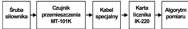
Rys. 12. Schemat blokowy toru pomiaru przemieszczeń Fig. 12. Block diagram of pusher displacement measuring channel
