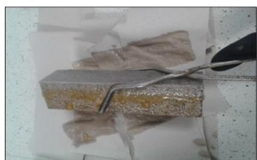
Rys. 5. Substancja żelowa wytworzona na powierzchni zaprawy w środowisku korozyjnym roztworu HCl
