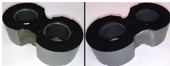
Rys. 4. Zdjęcia powierzchni pokrytych materiałami polimerowymi: FEP – po lewej; PFA – po prawej
