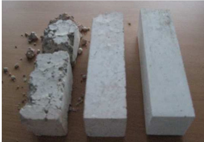
Rys. 5. Próbki drugiej serii badań 30 dni po wygrzewaniu; próbki z betonu od lewej: na kruszywie żwirowym, na kruszywie granitowym, na kruszywie z odpadów ceramiki sanitarnej
