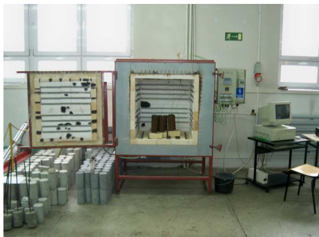
Rys. 2 Stanowisko do wygrzewania próbek: a) schemat, b) piec z próbkami
