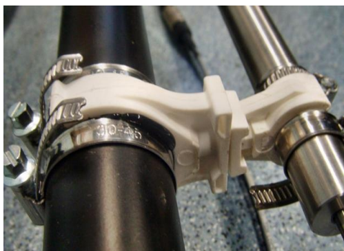
Rys. 5. Widok modyfikacji stanowiska pomiarowego (lokalizacja czujnika przemieszczeń)
