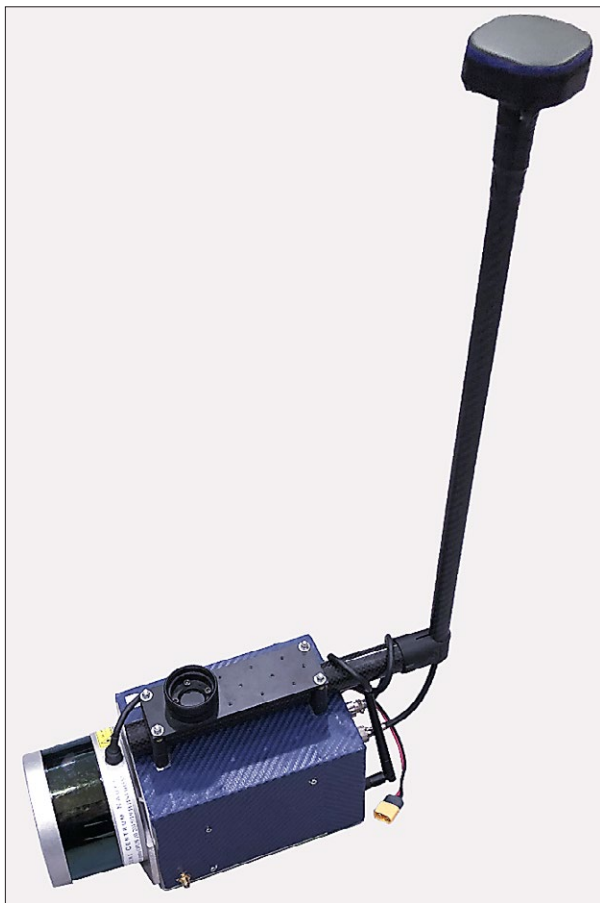
Fig. 7. The LiDAR system assembled at LabScan3D and used in the study; photo by J. Kościuk. Ryc. 7. System LiDAR złożony w LabScan3D i wykorzystany w badaniu; fot. J. Kościuk.
