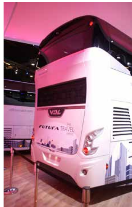
Tylna ściana autobusu piętrowego różni się jedynie wysokością i dodatkowymi wlotami powietrza chłodzącego
