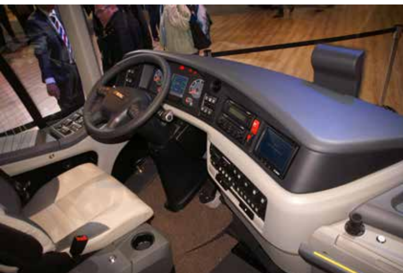
Nowe stanowisko kierowcy z multifunkcyjną kierownicą
