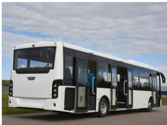
VDL Citea LLE 120 z układem drzwi 1-2-1. Wprowadzenie trzecich drzwi ma przede wszystkim skrócić czas postoju na przystankach
