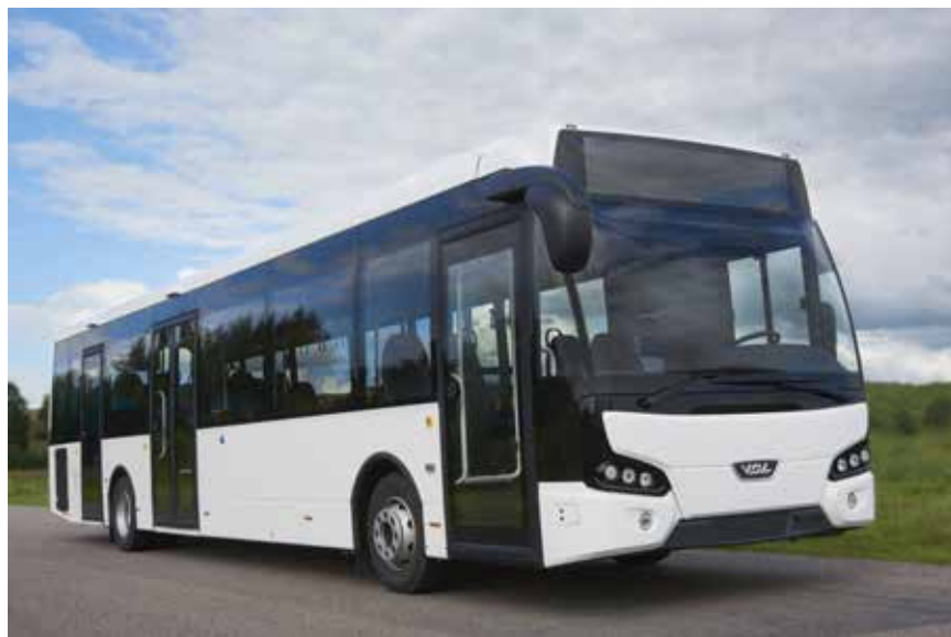
VDL Citea LLE 120 z układem drzwi 1-2-1. Wprowadzenie trzecich drzwi ma przede wszystkim skrócić czas postoju na przystankach
