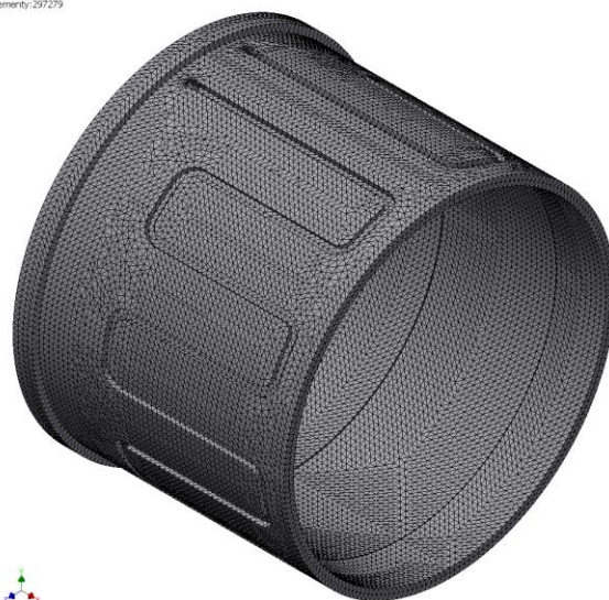
Rys. 2. Przykładowa siatka elementów skończonych
