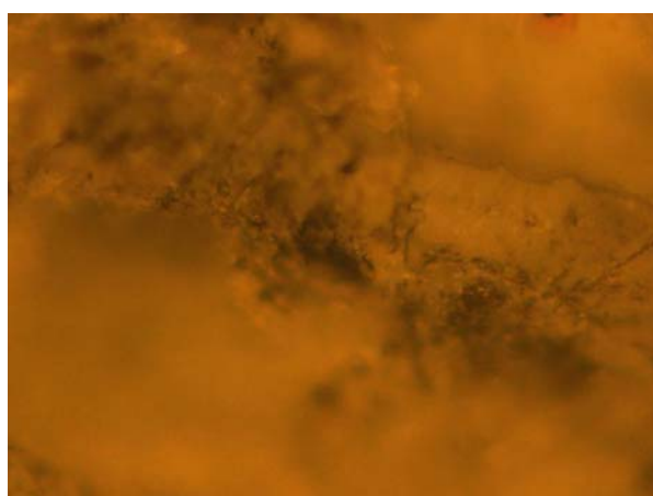
Ryc. 9. Fr. Smuglewicz (?), Alegoria (MNK). Badania metodą spektroskopii Ramana. Wyniki badań linii rysunku wykonanej czarnym tuszem. Obecność pasm: 1605 oraz 1319 \text{cm}^{-1} oraz brak pasma około 2650 \text{cm}^{-1} świadczą o węglu amorficznym
